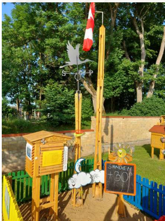
Meteorologinė aikštelė su pagrindiniais prietaisais: vėjarodis, kritulmatis, termometras
